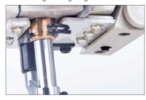
简便的LED包围式强冷光灯,使光源更加均匀,无阴影,不发热,节能环保。
