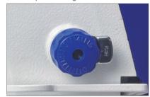
标盘止动机构的设计,提高针距的稳定性。确保缝制产品的效果更好,线迹更 美观。
