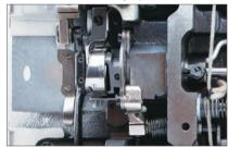
采用稳定、准确、高性能的切线机构, 以确保快速、果断的切线效果。无需调 整机构就可保证厚料粗线的切线效果。
